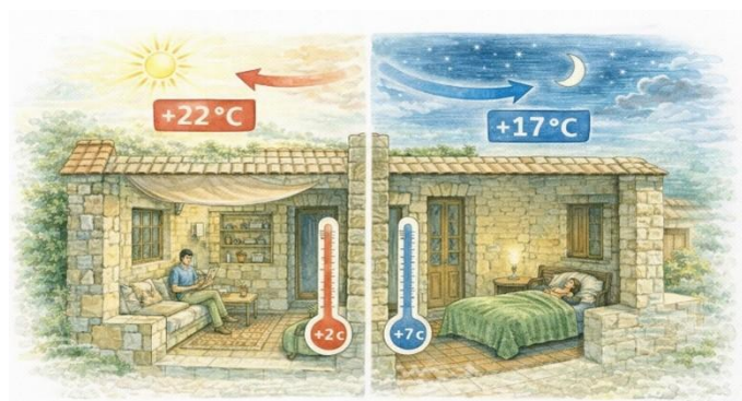
Рисунок 3. Тепловая инерция толстых каменных стен в традиционных средиземноморских жилых зданиях (рисунок автора)
