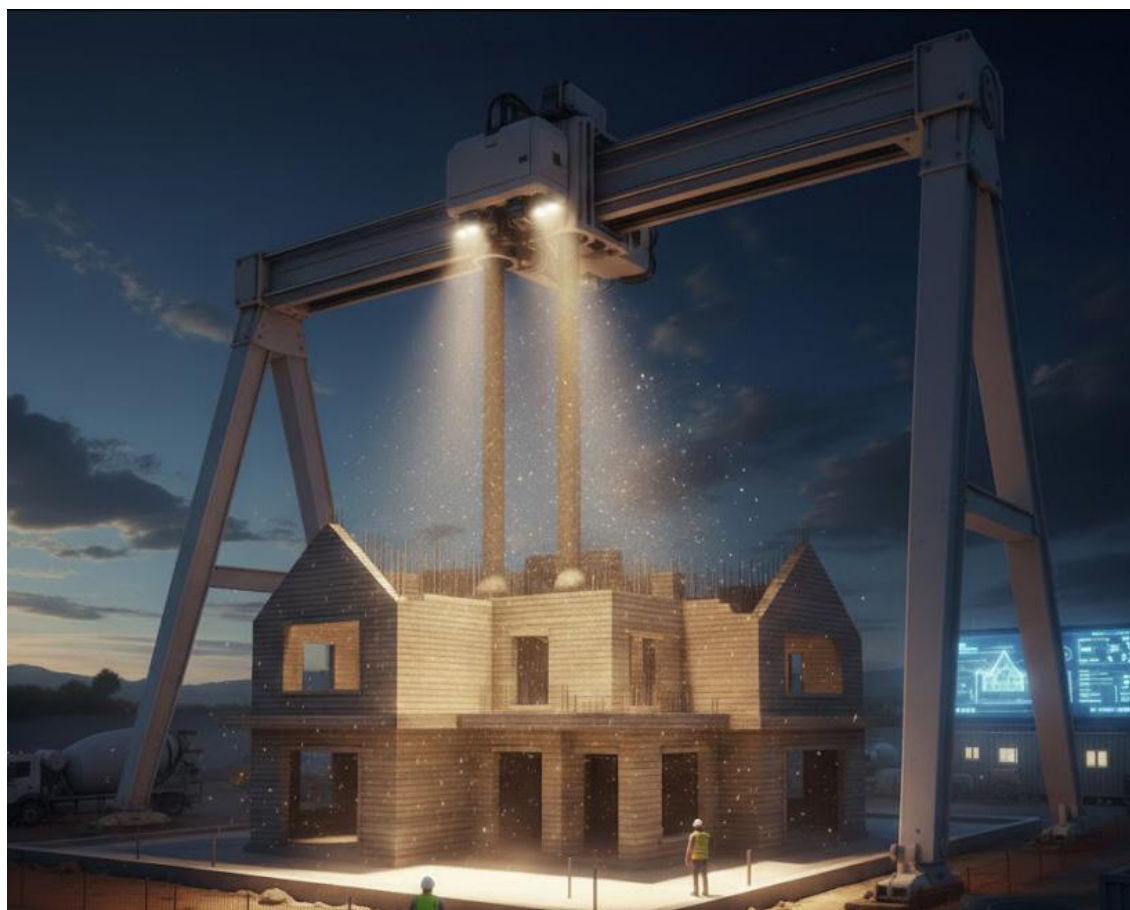
Рисунок 1. Бетонная 3D печать на строительной площадке: схема процесса (автор Денис Якушев)
