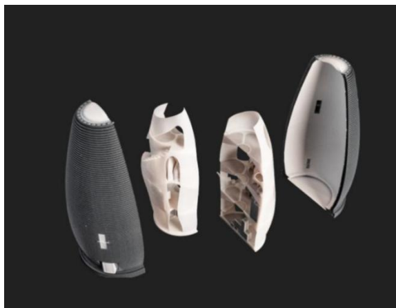
Рисунок 2. Концепция двойной оболочки: изоляция жилых пространств от конструктивных напряжений, вызванных экстремальными температурными колебаниями. ( https://spacefactory.ai/marsha ).
