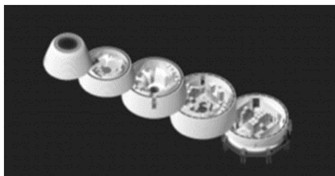
Рисунок 8. Поэтажная схема вертикального яйцевидного здания ( https://spacefactory.ai/marsha )
